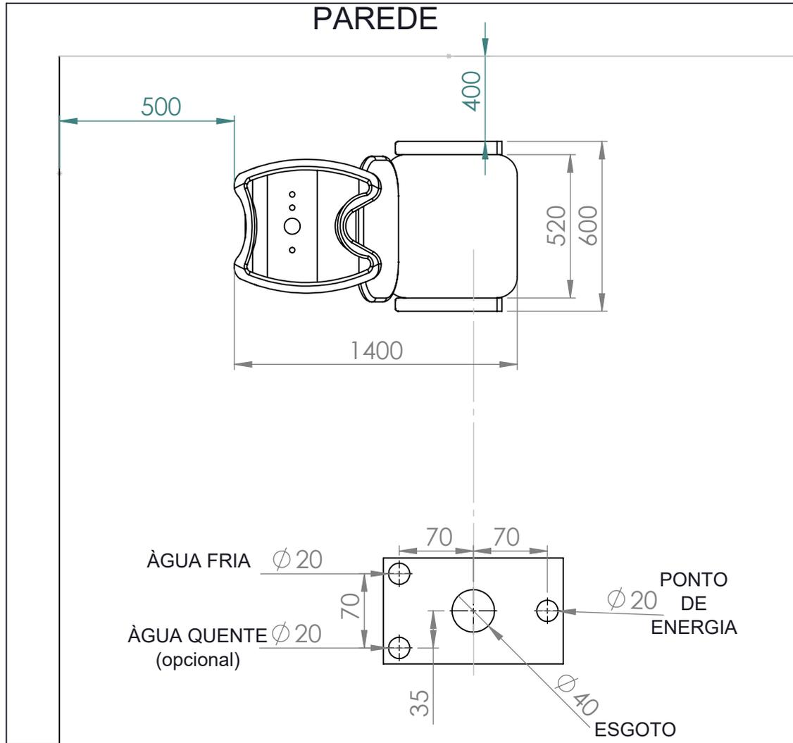
Esquema de instalação
